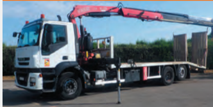
Porte engins 6x2 IVECO Stralis 360 Grue Fassi F170 A2.2 + treuil fond plateau
